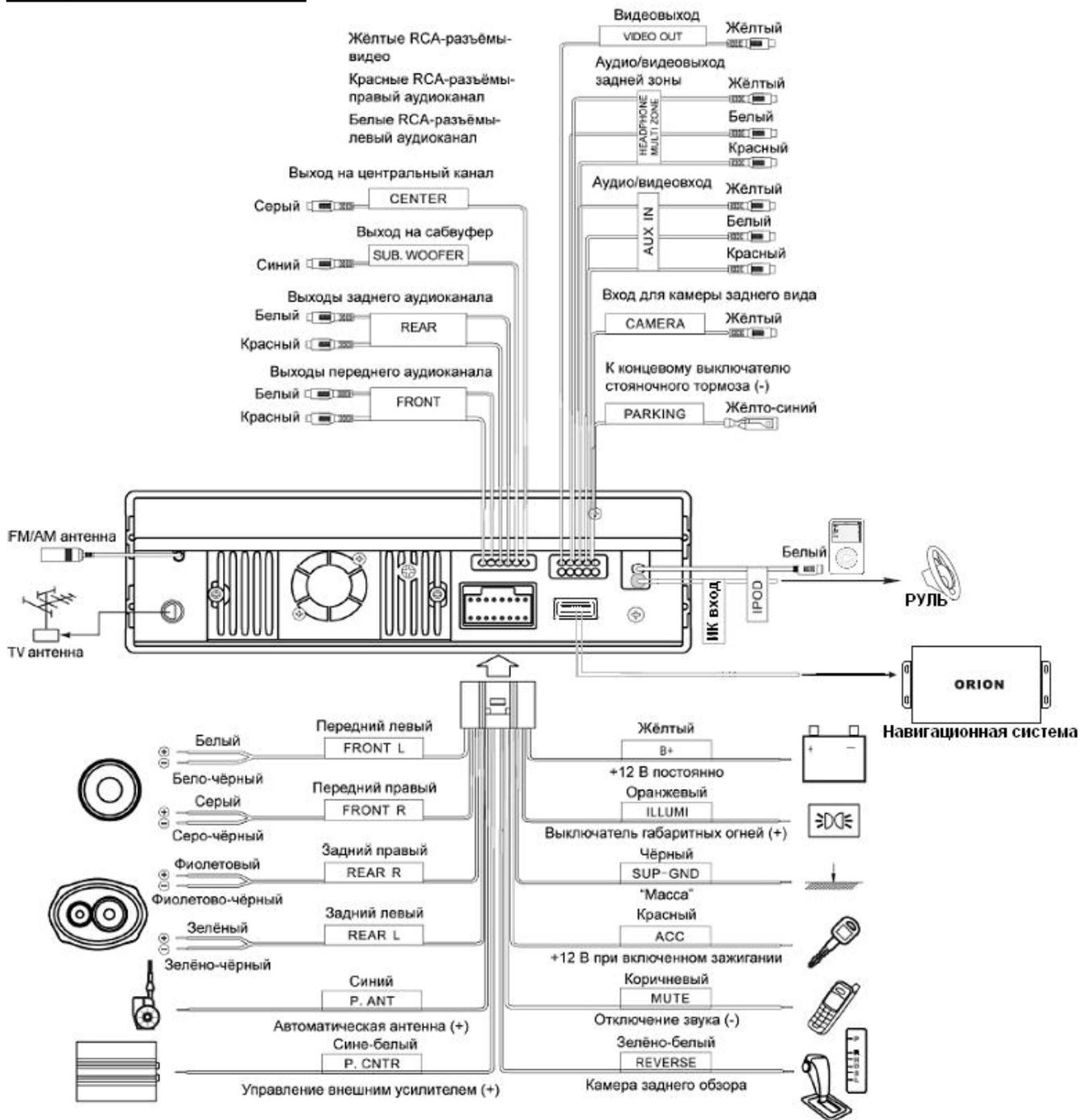
**Внимание!** В данном DVD-ресивере используются усилители мощности, подключенные по мостовой схеме. При подключении динамиков не допускается замыкание проводов на массу автомобиля или друг с другом.
