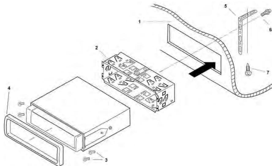
1. Вставьте **монтажный кожух (2)** в шахту (**приборную панель (1)**) и при помощи отвертки отогните металлические петли (язычки) чтобы зафиксировать кожух на месте. Выберите те язычки, которые соответствуют толщине приборной панели.
