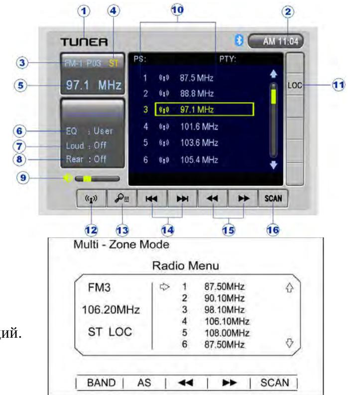
Если в режиме двухзонавого воспроизведения для передней зоны выбран режим радиоприёмника, на передний экран выводится меню, несколько отличное от меню в обычном режиме, однако все кнопки управления имеют те же функции.
