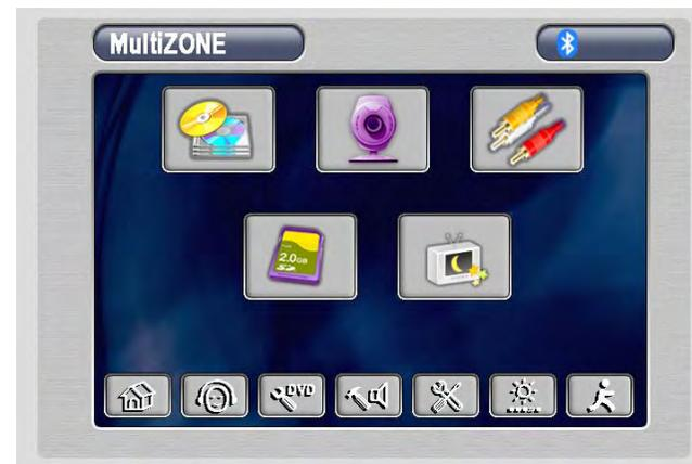
Для выбора режима воспроизведения либо включения/выключения задней зоны нажмите на соответствующую сенсорную кнопку на экране. Для отключения задней зоны нажмите и удерживайте кнопку **SRC** на передней панели.
