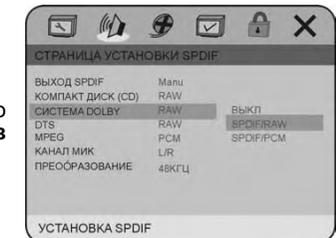
2.3) при виборі ручного вибору типу виходу аудіо (manual) встановити **тип виходу аудіо для дисків з DTS Digital**
