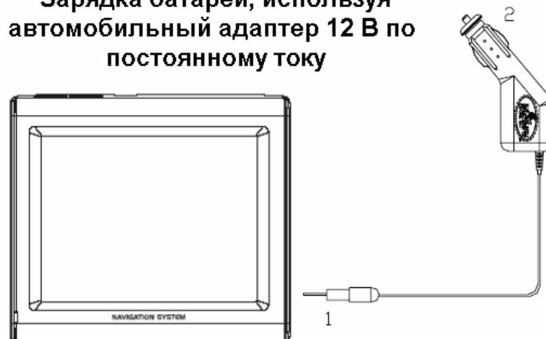
1. Подсоедините автомобильный адаптер по постоянному току (12 В) к гнезду питания, расположенному справа на устройстве (позиция 1 на рисунке).
